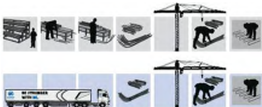
Figur 11 - Manuell tillverkningsprocess av armeringsbur (Begroup, 2016)
