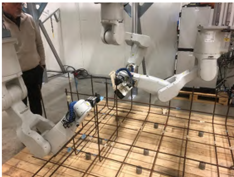
Figur 15. Utprovning av algoritmerna för banplaneringen. I figuren visas två robotar som håller i ett C-järn medan den tredje roboten najar fast järnet.
