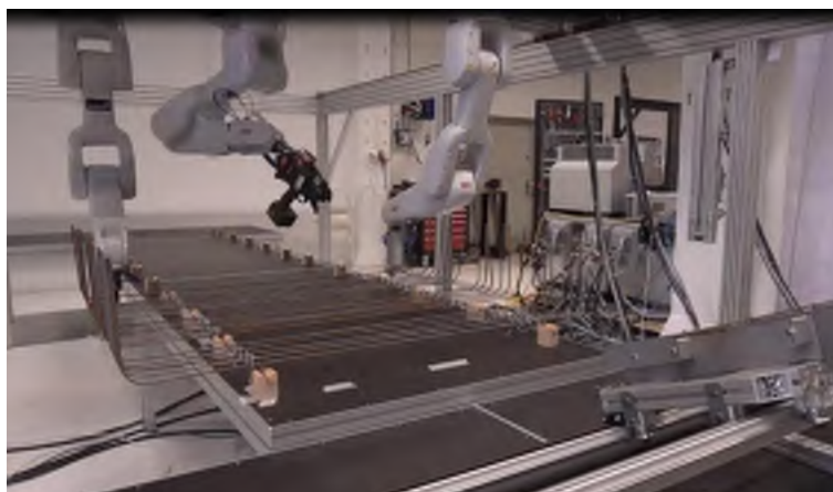
Figur 7. Den första versionen av demonstratorn i laboratoriet i Robot Application Center (RAC) i Eskilstuna. Demonstratorn har tre robotar som hänger i bommar (tvärgående balkar) som kan röra sig utmed två längsgående balkar. Robotarna kan därmed röra sig i x- respektive y-led. I denna version av demonstratorn kunde robotarna inte röra sig i z-led (vertikalt).
